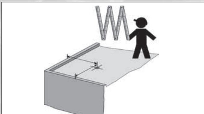
1. Misurazione e posizionamento del punto di ancoraggio
