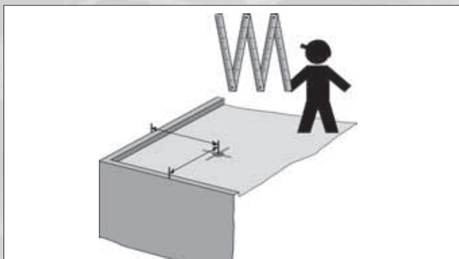
1. Misurazione e posizionamento del punto di ancoraggio
