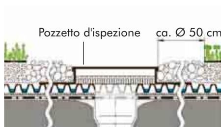
Il drenaggio dei tetti piani avviene di regola tramite gli scarichi. I pozzetti d'ispezione consentono l'accesso agli scarichi in qualsiasi momento e ne permettono la pulizia.
